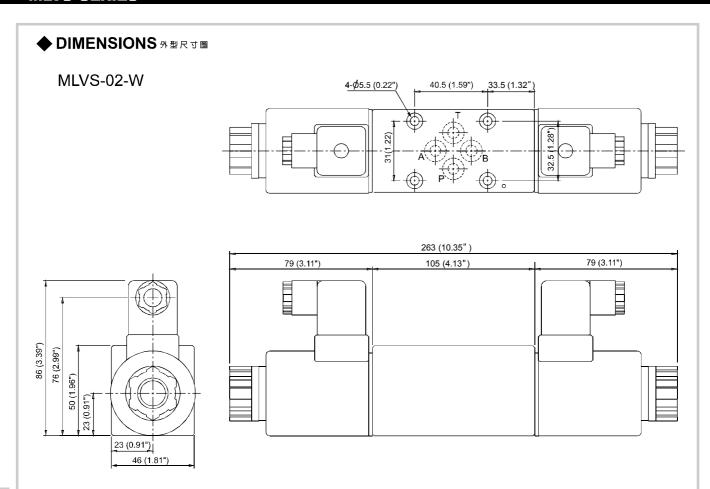
◆ Mounting Interface 基座尺寸圖 ISO 4401-AB-03-4-A
